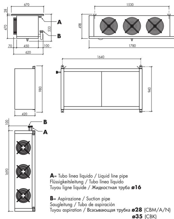
**A**= Tubo linea liquido / Liquid line pipe
